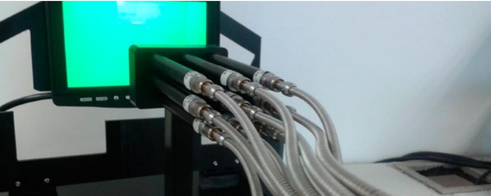
Der Feasa Display Analyser ist in der Lage, die Leuchtdichte, das Farb- und Kontrastverhältnis eines Automotive Displays zu testen. Dieser Analyser besteht aus einem Messkopf, Lichtfaserkabel und einem Mehrkanal-Sensormodul. Der Feasa Display Analyser ist in den Konfigurationen 3, 6 und 10 Kanälen erhältlich. Über die Daisy Chain Verbindung kann die Anzahl der Kanäle eines Mehrfachmoduls zusätzlich erhöht werden.
